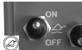
REMARQUE : L'interrupteur est installé sur le tableau de bord, également dans les cas où l'option de flottaison du bras de levage n'est pas installée sur le chargeur. La présence de l'interrupteur ne signifie pas que les options de flottaison du bras de levage ou d'entraînement en douceur sont fixées.
