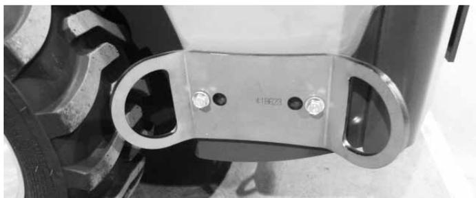
Attachez l'œillet d'arrimage réf. A418623 installé sur le côté du châssis arrière. Deux œillets sont nécessaires pour l'installation sur les côtés.
