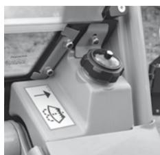
Le réservoir de liquide lave-glace et le bouchon de remplissage sur les machines ayant la cabine LX et DLX sont placés à l'extérieur de la cabine, à l'avant du pare-brise à gauche.
