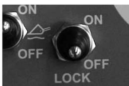
**VERROU DÉACTIVÉ :** Dans ce mode, l'huile hydraulique s'écoule en série du moteur pour retourner à ce dernier. Les roues tournent plus librement et le chargeur laisse moins de marques de pneu sur des surfaces souples.
