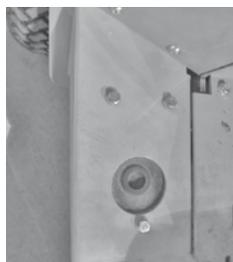
Sur les machines ayant la cabine L, le réservoir se trouve derrière la roue gauche avant et l'ouverture de remplissage est situé sur le repose-pied.
