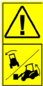
**Risque de basculement - Gardez toujours les charges près du sol.** La stabilité et la capacité de manipulation des charges du chargeur sont considérablement réduites sur des terrains inclinés et la capacité de levage maximale ne peut être atteinte que sur un sol ferme et horizontal. Sur des terrains à inclinaison horizontale, la charge doit être maintenue près du sol et ne doit jamais être levée en hauteur.
