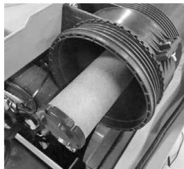
7. Un séparateur d'eau doté d'un filtre se trouve également dans le système de carburant. Le filtre de séparateur d'eau n'est pas inclus dans le kit de filtre et ne doit pas être remplacé, sauf s'il se brise. Le n° de pièce du filtre du séparateur d'eau est de 64963.
