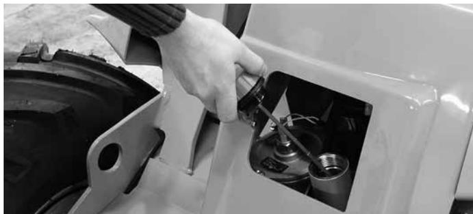
1. Marqueur de cible. Remplissez jusqu'à cette marque lorsque le système hydraulique est froid. La zone mise en évidence dans la figure présentée ci-dessus montre approximativement le niveau acceptable.
