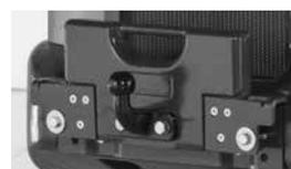
La quantité max. des poids supplémentaires (29 kg/pièce) est de 3 pièces. Si la machine est équipée d'un poids supplémentaire avec attelage de remorque, la quantité max. des poids supplémentaires (29 kg/pièce) est de 1 pièce. Le chargeur peut également être équipé d'un kit de poids latéral supplémentaire (80 kg ou 180 kg) qui se monte derrière les roues arrière.
