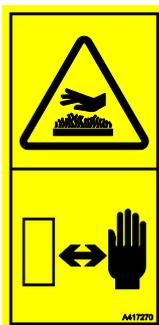
**Risque de brûlures - Pièces chaudes.** Laissez refroidir le moteur avant d'accéder le compartiment moteur. Le moteur et les pièces d'échappement peuvent être extrêmement chauds après l'utilisation.
