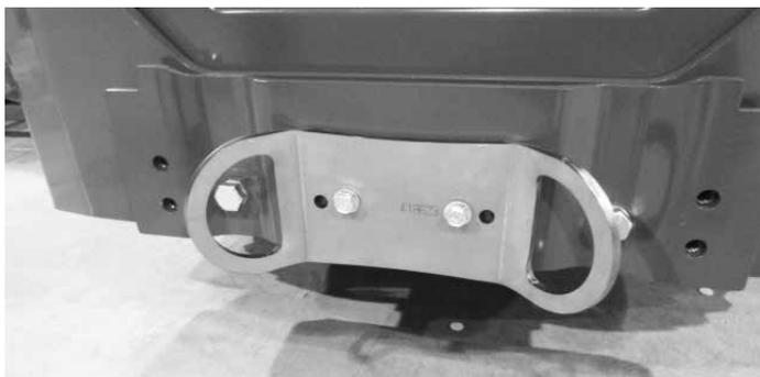
Attachez l'œillet d'arrimage réf. A418623 installé au pare-choc arrière ou au contrepois
