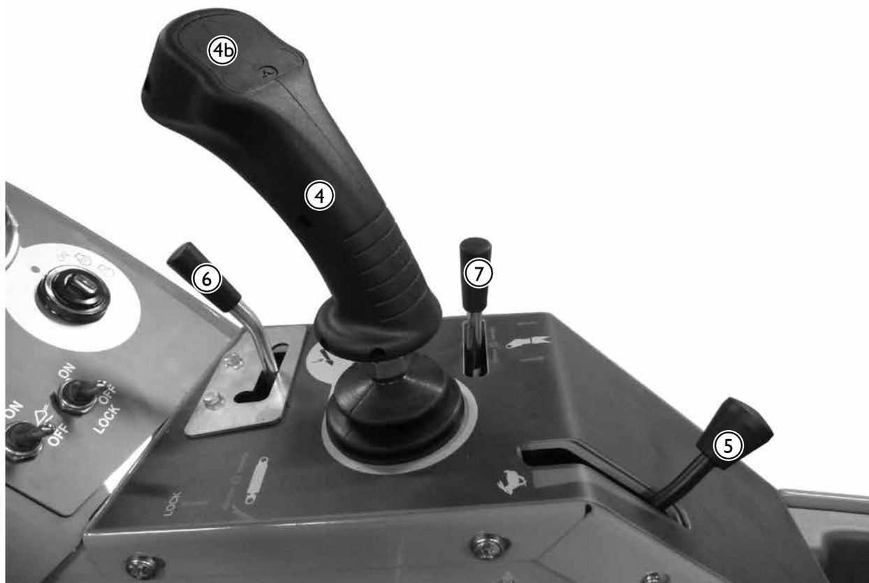
**4. Levier de commande du bras de levage et godet**
