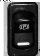
Le frein de stationnement s'engage automatiquement lorsque le moteur est arrêté. Le frein peut être relâché uniquement lorsque le moteur est en marche et qu'il y a de la pression hydraulique dans le système.
