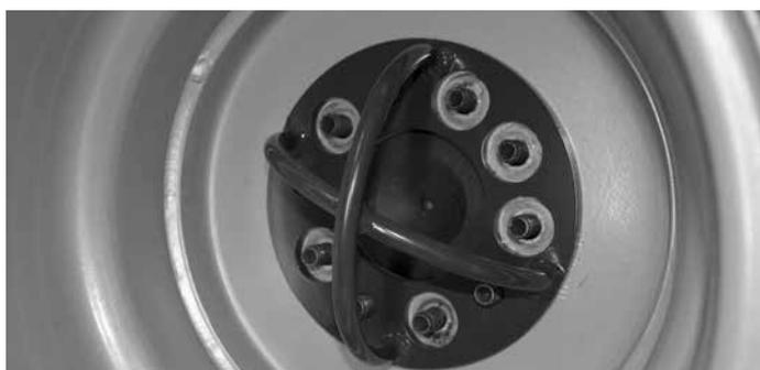
L'œillet d'arrimage sur le moyeu de la roue, réf. A423091
