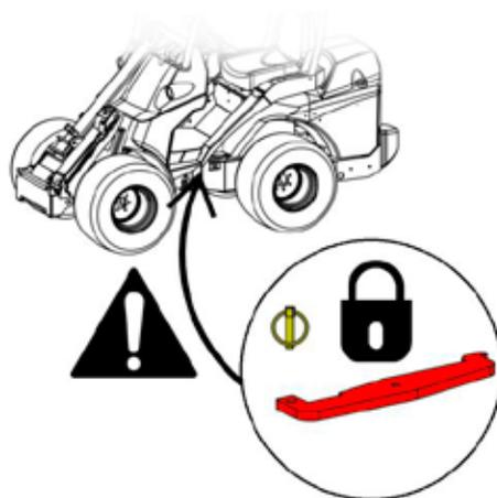
Fermez toujours le verrou de châssis avant de transporter ou de lever le chargeur. Rappelez-vous également de retirer le verrou de châssis et de tester le braquage du chargeur après le transport.
