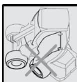
Ne conduisez pas avec la porte de la cabine ouverte, ni ne tournez pas le volant lorsque la porte de la cabine est ouverte. La porte peut se briser au contact avec les roues.
